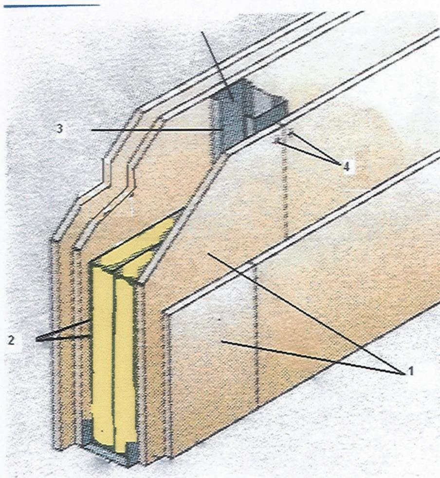
1) Lastre in fibro silicato di calcio esterna spessore 12 mm dens. 900 Kg/m<sup>3</sup> interna spessore 10 mm dens. 900 Kg/m<sup>3</sup>
