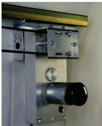
In alternativa alla centrale **E8** può essere fornita la centrale (quadro di comando Square 800) centrale a microprocessore multifunzione che consente anche l'apertura parziale per passaggio persone e il funzionamento senza finecorsa della motorizzazione tramite encoder aggiunto alla stessa.
