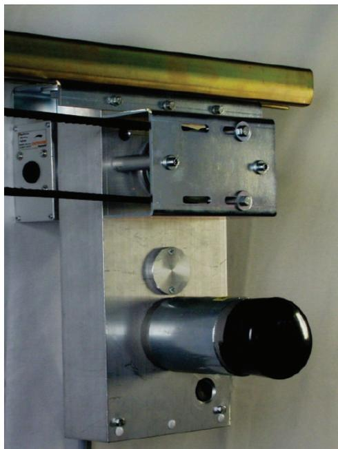
Il **DICTAMAT 3700** è una motorizzazione **Dictator** specifica per porte e portoni scorrevoli antincendio dotati di c1peso, a una o due ante a chiusura centrale. Extracompatta e ambidestra è in grado di movimentare velocemente un'anta fino a 700 Kg di peso. Essendo modulare può essere addizionata anche in un secondo tempo con un riduttore aggiunto che aumenta la trazione, la velocità in apertura e chiusura è regolabile a piacere separatamente.
