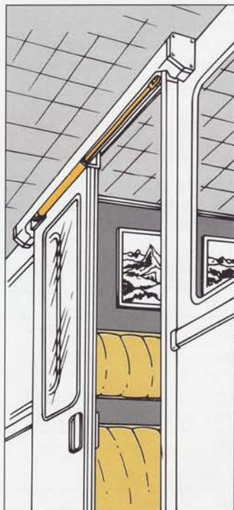
Una "normale" molla a gas deve essere installata con lo stelo inclinato verso il basso. Se al contrario volete installare delle molle a gas su porte scorrevoli o a battente in **posizione orizzontale**, per la DS Dictator non ci sono problemi. Le nostre molle a gas speciali con **camera idraulica e paraolio** particolare consentono montaggio orizzontale e durata analoga ad una normale molla a gas.
