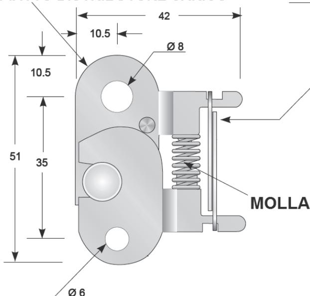
Termofusibile con distribuzione di carico per fissaggi diversi.
