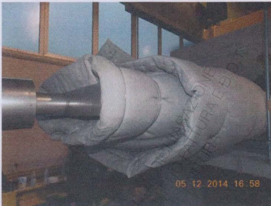
Foto 5. Canalina 600x80 mm: campione di prova in allestimento
