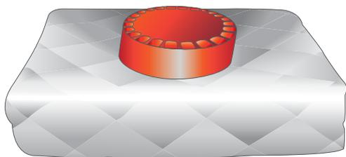
La protezione antincendio per anemostati e diffusori aria condizionata **DS STOP FIRE** consiste in una semiscatolatura in fibra antincendio con copertura in stagnola d'alluminio (con lato inferiore aperto) sulla quale va ricavato un foro per il passaggio del tubo spiralato con copertura in termoplastico leggero per alimentazione dell'aria sul quale si monter , sopra alla protezione, il collare antincendio **DS STOP FIRE** di diametro analogo al tubo in opera.
