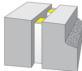
Grazie alla notevole elasticità il giunto **DS STOP FIRE S** può essere utilizzato anche come giunto antincendio antisismico essendo certificato anche con larghezza 100 mm e con lamiera di sostegno.
