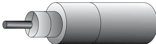
L'isolamento termico delle coppelle **DS STOP FIRE CP** impedisce la dilatazione (l'allungamento) e quindi il collasso, in caso di incendio, della volta del tetto e delle strutture con classificazione R 180, R120 oppure R60.
