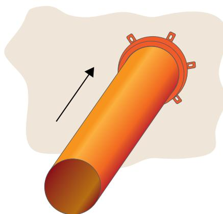
4 Spostare il collare **DS STOP FIRE MT** e fare i buchi nel muro o nel solaio infilando i tasselli ad espansione.
