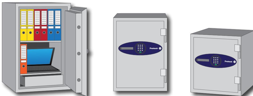
Gli armadi antincendio **DS STOP FIRE** sono costituiti da un armadio isolante con sovrastruttura in lamiera con telaio per porta a battente dotato di guarnizioni termoespandenti e guarnizione in gomma di serraggio contro la penetrazione di fiamme e gas.
