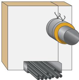
Estrudere del mastice termoespandente **DS STOP FIRE MW** dalla cartuccia da 310 ml, spalmare sulle pareti per ca. 2 cm su tutto il perimetro del foro verniciando la superficie dei batuffoli incastrati nelle piccole fenditure utilizzando spatola o pennello.
