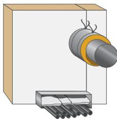
Estrudere del mastice termoespandente **DS STOP FIRE MW** da una cartuccia da 310 ml e sbordare sulle pareti per ca. 2 cm su tutto il perimetro del foro muro; verniciare la superficie dei batuffoli incastrati nelle piccole fenditure utilizzando spatola o pennello.
