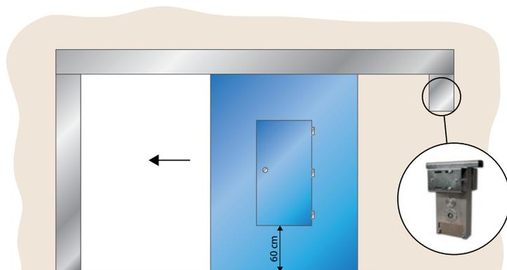
La barriera scorrevole anti allagamento **DS STOP WATER B** serve ad impedire l'allagamento dall'esterno dell'edificio oppure la dispersione di acque con schiuma di impianti di spegnimento dall'interno dell'edificio nella rete fognaria.
