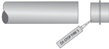
Spalmare i nipi maschi di condotte femmina o le flange da imbullonare di condotte rettangolari con silicone **DS STOP FIRE S** prima dell'innesto.
