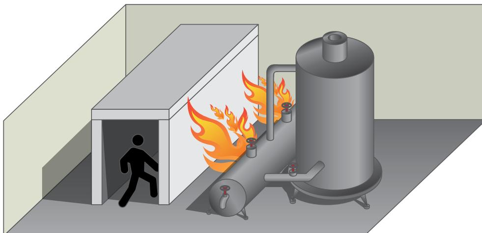
La **DS DICTATOR** fornisce (con posa in opera su richiesta) tunnel antincendio composti da pannelli di tipo "sandwich" per permettere il passaggio sicuro di persone e oggetti verso le uscite d'emergenza costruite nelle vicinanze di impianti a rischio di incendio.
