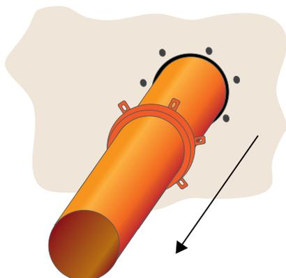
**4** Rimettere il collare **DS STOP FIRE RSE** in posizione e stringere forte bloccando i tasselli, usare delle ranelle con diametro esterno il più grande possibile sopra le alette del collare.
