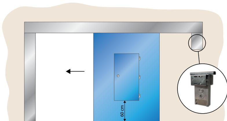
Il portone scorrevole anti allagamento **DS STOP WATER P** ha funzione di normale portone scorrevole industriale automatico con montaggio all'esterno dell'edificio, ma è dotato di guarnizione in gomma pesante che, a fine corsa, si abbassa a terra e, contemporaneamente, si accosta alla parete chiudendo ermeticamente il passaggio con soglia in lamiera pesante spessore 5 mm da murare a pavimento.
