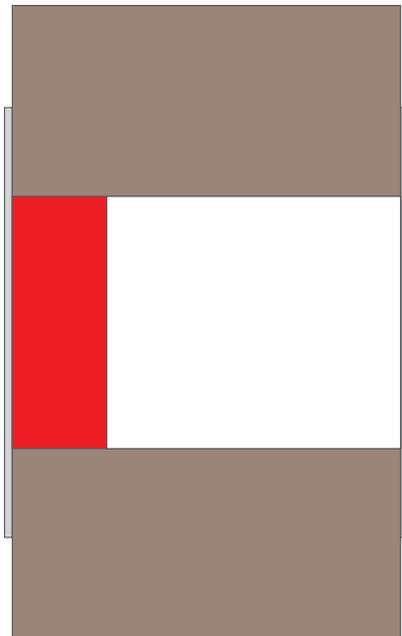
Carotare la parete con un diametro leggermente maggiore di 200 mm, estrarre sulla superficie interna della sezione della parete carotata il silicone **DS STOP FIRE S**, in modo che la bocchetta rimanga incollata dal silicone.
