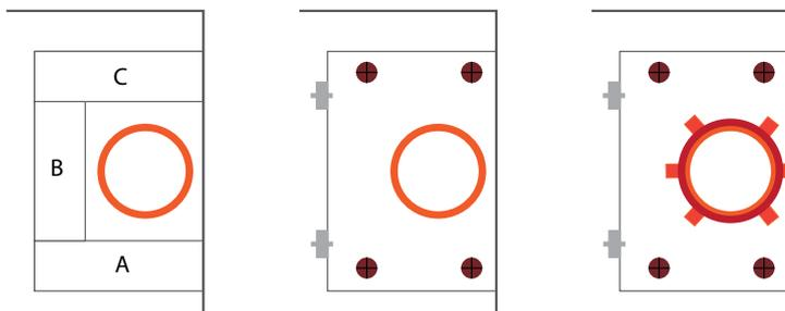
Fissare il collare sulla scatola con viti da truciolare sopra al tubo di scarico in plastica.
