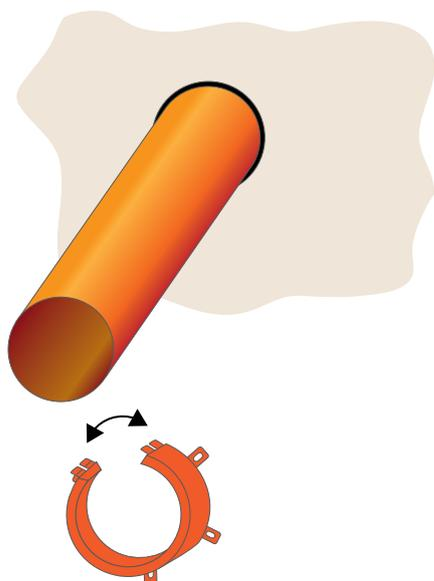
2 Chiudere il collare **DS STOP FIRE RSP** e appoggiarlo al solaio, segnare sul solaio la posizione dei fori tramite le alette del collare.
