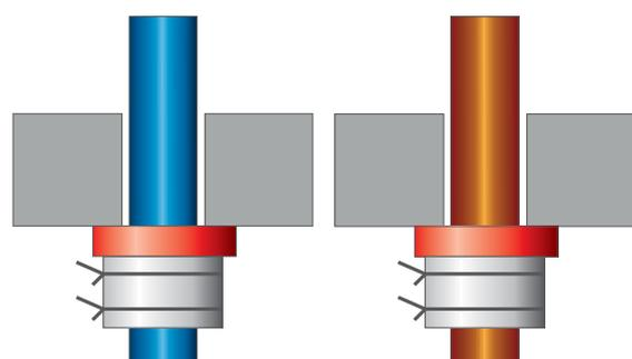
La stessa procedura è analoga per parete o solaio. Solo per il solaio fasciare il filo di ferro con nastro in alluminio.
