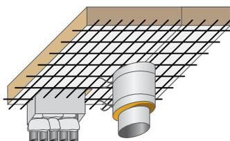
Estrudere del mastice termoespandente **DS STOP FIRE MW** da una cartuccia da 310 ml e verniciare eventuali tubi in ferro e condotte aerauliche per ca. 5-10 cm con uno strato abbondante di **DS STOP FIRE MW** al di fuori del filo della barriera.
