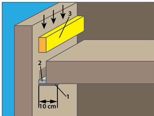
1. Posare un angolare in lamiera zincata 10 x 10 cm fissandolo al solaio esclusivamente con tasselli in ferro  $\varnothing$  8 mm a interasse 50 mm più largo di 5 cm del foro giunto contro il soffitto.
