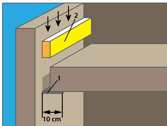
1. Posare un piatto in lamiera zincata larghezza 10 cm fissandolo al solaio esclusivamente con tasselli in ferro  $\varnothing$  8 mm a interasse 50 mm più largo di 5 cm del foro giunto contro il soffitto.
