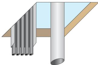
La passerella metallica dovrà esser dotata di coperchio metallico almeno nel tratto di attraversamento della barriera nel solaio.
