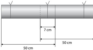
Tagliare i moduli **DS STOP FIRE WRP 2-T** in cantiere con un cutter calcolando la circonferenza del tubo più un sormonto di almeno 7 cm sul totale.
