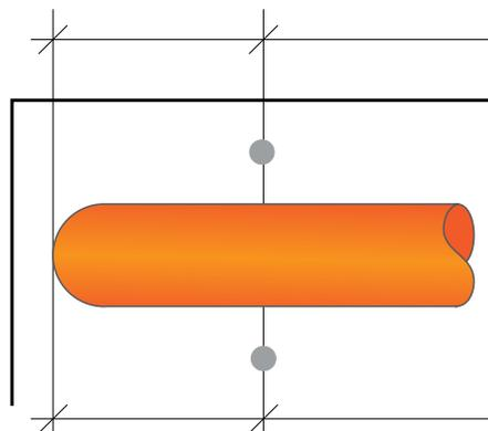
Fissare 2 barre filettate M8 in ferro usando solo tasselli in ferro.
