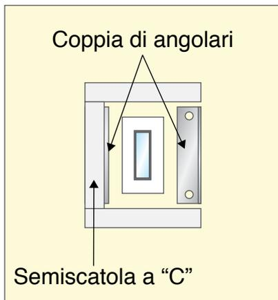
Scatolatura costituita da lastre in calcio silicato **DS STOP FIRE CSC** e guarnizione termoespandente **DS STOP FIRE LGR** fissate su supporto a "L" su 2 lati parete.
