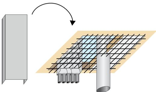
Se il foro del solaio è maggiore di 900 x 500 mm, fissare una rete metallica da fondazione 10 x 10 cm Ø 5 mm con tasselli metallici sul soffitto, scantonandola per far passare gli impianti (tubi, passerelle).
