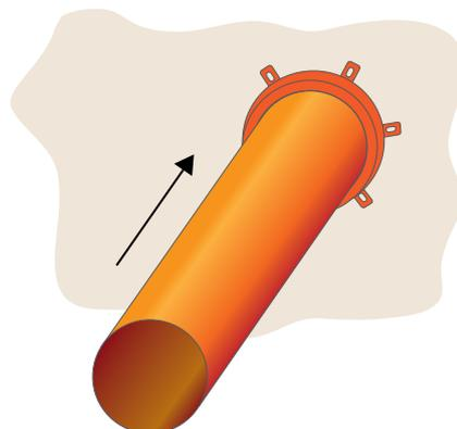
5 Forare la barriera antincendio **DS STOP FIRE C/MW** con barre filettate con diametro come i fori delle allette dei collari, posizionando sui 2 lati della barriera dadi su rondelle con diametro esterno maggiorato stringendo i dadi sul barre filettate.
