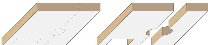
Tagliare in misura il pannello di **DS STOP FIRE C/MW** sagomandolo a seconda degli impianti che attraversano il foro del solaio.
