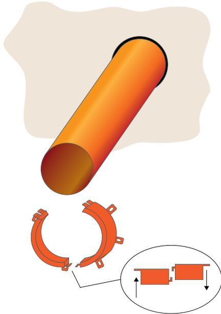
Chiudere il collare e appoggiarlo alla parete o al solaio, segnare sul muro o sul solaio la posizione dei fori tramite le alette del collare.
