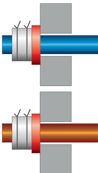
A seconda si tratti di tubo in ferro o rame, come da Norma EN posizionare sul tubo il **WRP LA** per tubi in ferro o il **WRP FA** per tubi in rame per una profondità di 50 cm eseguendo un doppio avvolgimento e legandolo con un paio di cappi di filo di ferro  $\varnothing$  1 mm per evitare la trasmissione di calore.
