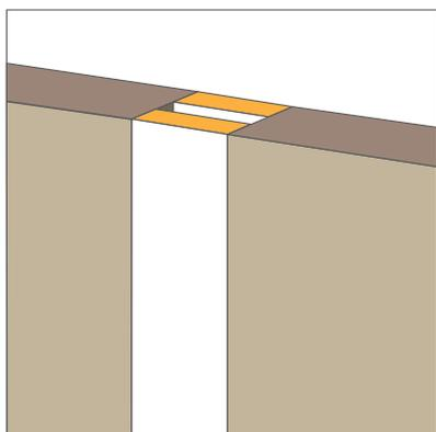
Il giunto è fornito pronto in pannelli termoespandenti già verniciati da tagliare su misura in cantiere e incastrare.
