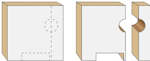
Tagliare il pannello di **DS STOP FIRE C/MW** sagomandolo a seconda degli impianti che attraversano il foro muro.
