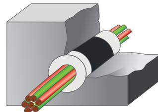
Se la carotatura è accessibile da un solo lato va prima iniettato il mastice intorno ai cavi poi eseguito l'avvolgimento e quindi iniettato l'ultimo strato di mastice.
