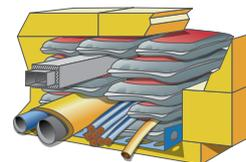
Le barriere costituite con sacchetti antincendio **DS STOP FIRE PS**, possono essere smontate, modificate e rimontate in tempi rapidissimi e i sacchetti sono sempre riutilizzabili.
