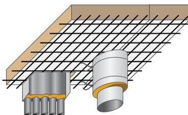
Incastrare i pezzi di pannello di **DS STOP FIRE C/MW** tamponando con batuffoli di lana minerale eventuali piccole fenditure libere da sopra la rete.
