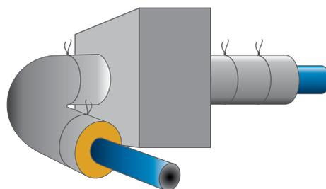
La barriera antincendio **DS STOP FIRE WRP LA** per singoli tubi in ferro murati è costituita da un wrapping di copertura **DS STOP FIRE WRP LA** in lana minerale impregnata con copertura esterna in stagnola di alluminio.
