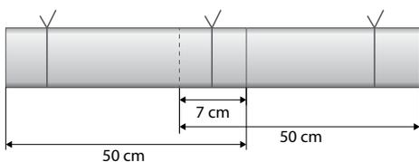
Sormontare il modulo **DS STOP FIRE WRP 2-C** per almeno 7 cm sia sul diametro che sulla lunghezza.
