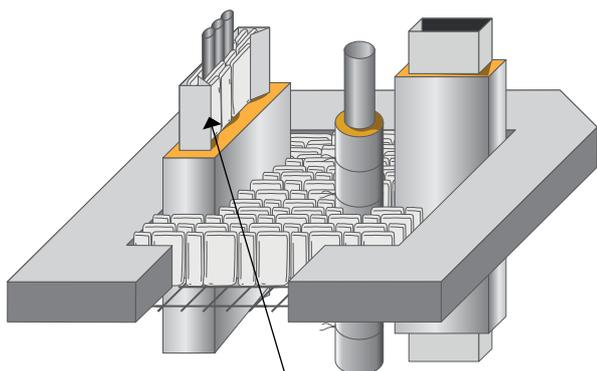
Passerella riempita di sacchetti con il wrapping montato sopra e sotto il solaio
