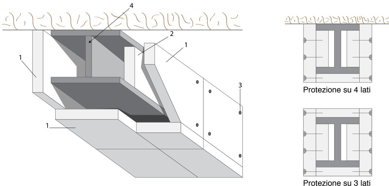
1. Lastra Classe A1 in calcio silicato **DS STOP FIRE CSC** con densità e spessore variabile a seconda della resistenza al fuoco necessaria.
