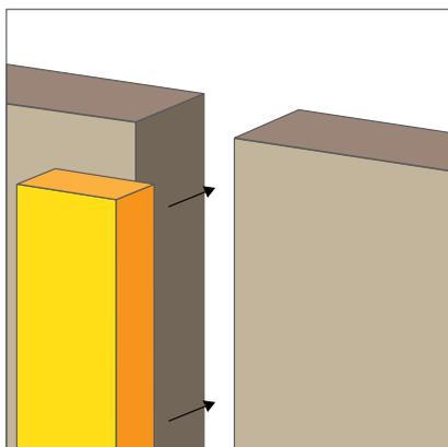
Sgrossare la superficie con spazzola da saldatura, introdurre e incassare sui 2 lati della parete i moduli di lana minerale **DS STOP FIRE** con spessore minimo 40 mm.
