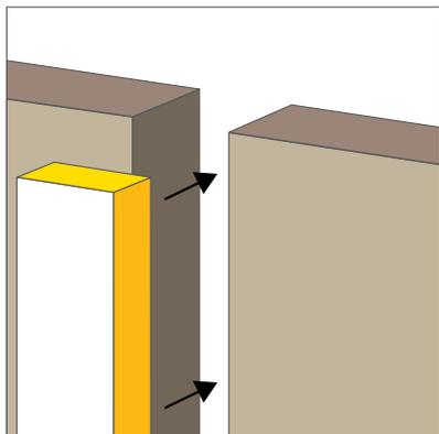
Sgrossare lo scasso con una spazzola da saldatura e incastrare i moduli di giunto antincendio **DS STOP FIRE CMW**.
