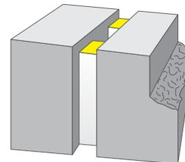
Il giunto **DS STOP FIRE CMW** non contiene amianto o sostanze dannose per la salute né prima, né durante, né dopo l'incendio. Non teme acqua, fotosintesi, muffe o gelo; una volta posato mantiene la propria elasticità permettendo le normali dilatazioni termiche stagionali degli edifici.
