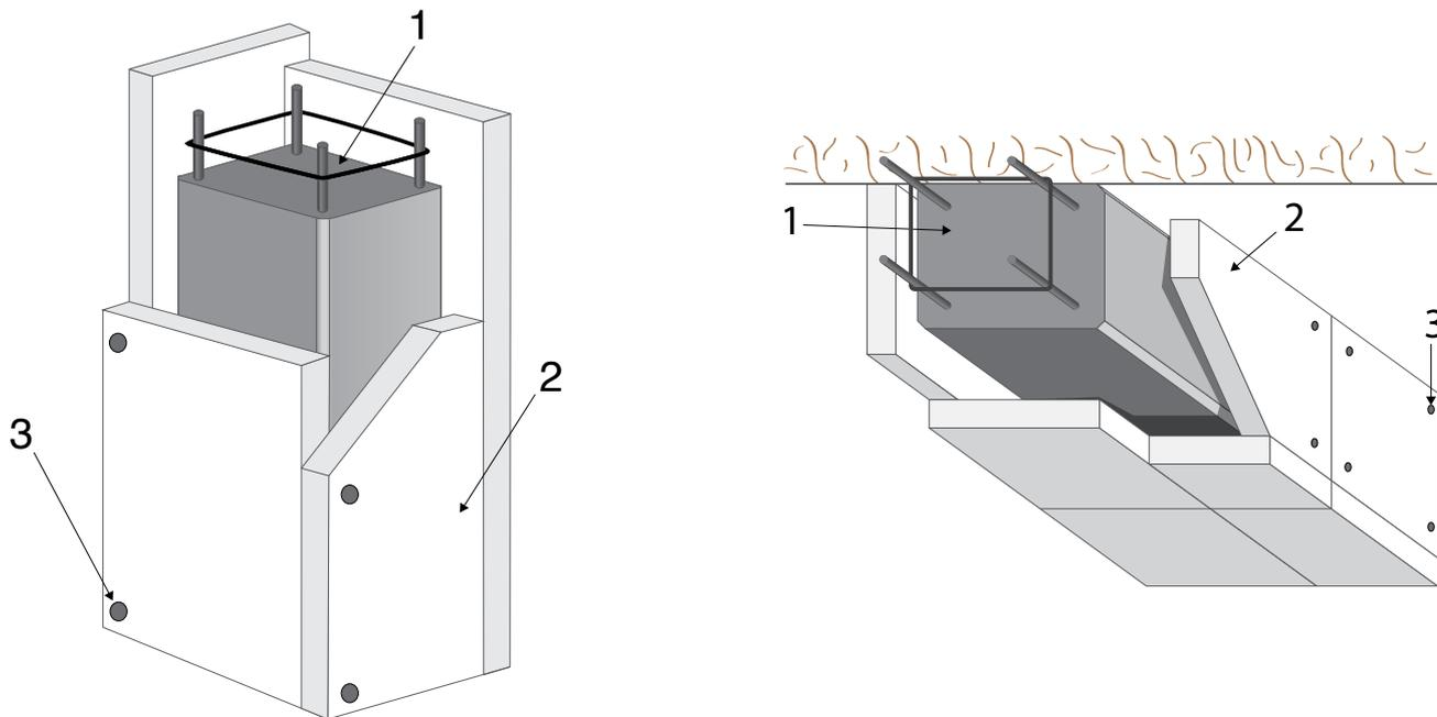
1. Pilastro in cemento armato con copriferro di calcestruzzo minimo 1 cm
