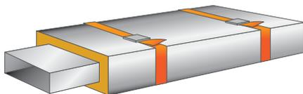
Avvolgere provvisoriamente su passerelle per facilitare il montaggio modulo **DS STOP FIRE WRP 2-C** con una coppia di cinghie da carico e fissarlo sulla condotta aereaica con fili in acciaio  $\varnothing$  1 mm con un interasse di 50 cm circa tramite nodo a torsione, quindi rimuovere le cinghie.
