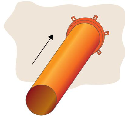
**3** Spostare il collare **DS STOP FIRE RSE** e fare i buchi nel muro o nel solaio infilando i tasselli ad espansione
