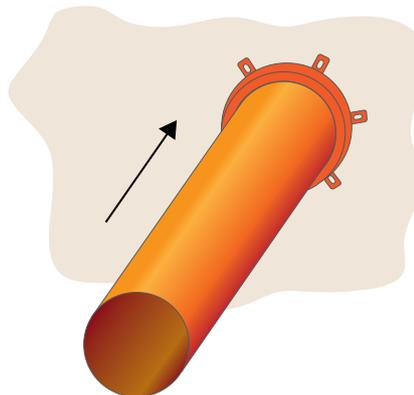
3 Spostare il collare **DS STOP FIRE RS** e fare i buchi nel muro o nel solaio infilando i tasselli ad espansione.
