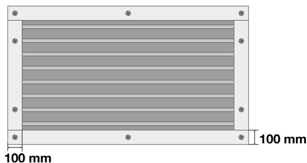
Inserire la griglia **DS STOP FIRE GA** e sovrapporre un cornice di cartongesso antincendio avvitato con viti per cartongesso come da disegno su 2 lati della parete.
