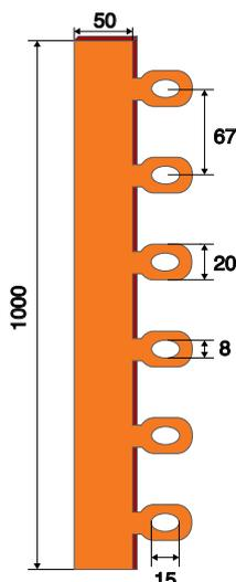
I collari antincendio **DS STOP FIRE MT** in banda servono per sigillare dal passaggio di fuoco, fumo e gas, i fori attraversati da tubi combustibili in materia plastica con diametri diversi ricavando il collare direttamente in opera formandolo attorcigliando la banda sul tubo da proteggere, segnando quindi con un "seghetto da ferro" la banda in misura e ottenendo così il collare della dimensione adatta.
