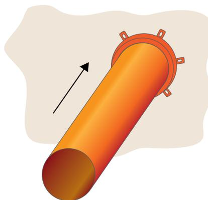
3 Spostare il collare **DS STOP FIRE RSP** e fare i buchi nel solaio infilando i tasselli ad espansione.
