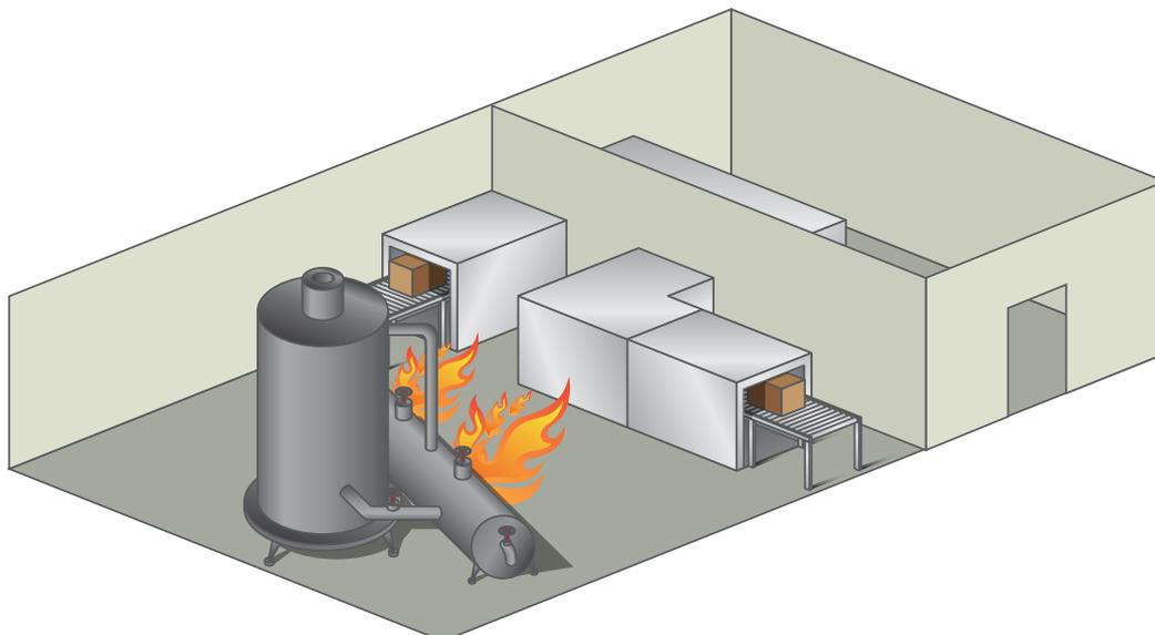
La **DS DICTATOR** fornisce (con posa in opera su richiesta) tunnel antincendio composti da pannelli di tipo "sandwich" per la copertura di impianti di trasporto a catena motorizzati che mettono in comunicazione diversi compartimenti (locali).
