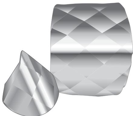
La protezione antincendio **DS STOP FIRE** per lampade a incasso consiste in una semiscatolatura in fibra antincendio con copertura in stagnola d'alluminio (con lato inferiore aperto) da posizionare sopra al controsoffitto sopra alla lampada da proteggere con uno spacco da ricavare sulla scatolatura per l'uscita del cavo elettrico di alimentazione.
