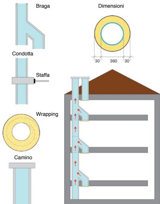
La condotta con canne Shunt **DS STOP FIRE** EI 120 serve per l'aerazione naturale di filtri a prova di fumo come.
