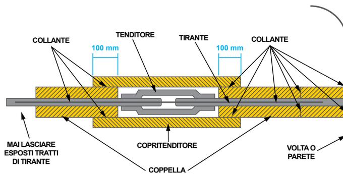
Esempio di protezione con coppelle antincendio **DS STOP FIRE CP** su capannone a volta.
