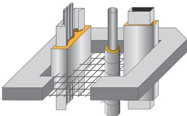
Sgrossare lo spessore del foro nel solaio. Fissare una rete metallica da fondazione 10 x 10 cm Ø 5 mm con tasselli in ferro sul soffitto inferiore o piegando i 4 lati nello spessore del solaio.
