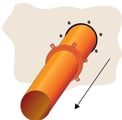
4 Rimettere il collare **DS STOP FIRE RS** in posizione e stringere forte bloccando i tasselli, usare delle ranelle con diametro esterno il più grande possibile sopra le alette del collare.
