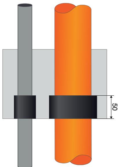
Il nastro antincendio **DS STOP FIRE NTF** serve per sigillare dal passaggio di fuoco e gas i fori solai in calcestruzzo attraversate da tubi combustibili in materia plastica (pvc, ecc...).
