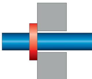
Montare il collare antincendio **DS STOP FIRE MT** tagliandolo in misura a seconda del diametro dei tubi da proteggere e fissandolo con tasselli esclusivamente metallici, accertandosi che il collare copra totalmente il diametro esterno della carotatura attorno al tubo.
