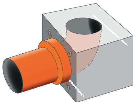
I collari antincendio con scatola **DS STOP FIRE CSC RS** servono per sigillare dal passaggio di fuoco, fumo o gas i fori in pareti verticali o solette orizzontali attraversati da tubi combustibili in materia plastica.
