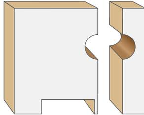
Tagliare il pannello di **DS STOP FIRE C/MW** sagomandolo a seconda degli impianti che attraversano il foro muro.
