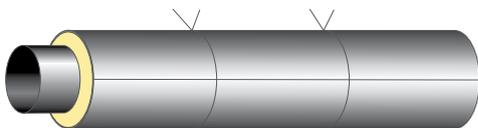
Avvolgere la condotta con 1 module di Ds Stop Fire WRP 2-C
