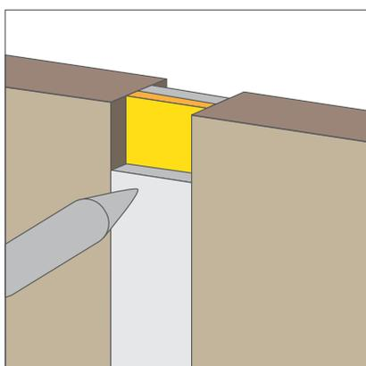
Estrudere uno strato di sigillante antincendio **DS STOP FIRE S** con spessore 5 mm sui 2 lati sopra la lana minerale.
