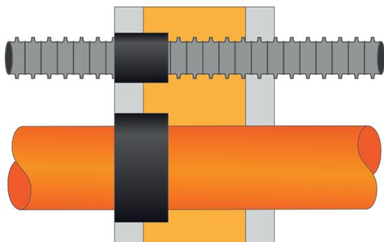
Il nastro antincendio **DS STOP FIRE NT** serve per sigillare dal passaggio di fuoco e gas i fori in pareti verticali attraversate da tubi combustibili e corrugati in materia plastica (pvc, ecc...).
