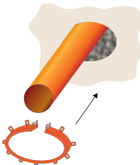
3 Fissare con tasselli ad espansione in ferro il collare utilizzando le sue asole sulla corona circolare del foro e legarlo con un doppio legaccio di filo di ferro.
